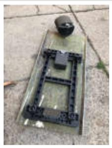
3. Und wenn man den Shopper dann an einem wie unter 1. vorbereiteten Rad nutzen möchte, klickt man die Adapterplatte (2.) in Sekundenschnelle auf die Trägerplatte (1.) und los geht die Fahrt. Die Stahlplatte im Bild wird übrigens grau lackiert übergeben; ggf. stellen wir sie auch in Edelstahl bereit, das können wir aber noch nicht versprechen.
