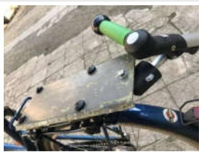
4. Um anderen den Shopper auszuleihen, löst man die Verbindung zwischen Träger- und Adapterplatte mit einem kleinen Schlüssel und klickt die Adapterplatte (2.) schnell auf ein anderes Rad, welches die Trägerplatte installiert hat (vom Nutzer oder Fahrradhersteller, der MIK bereits in seine Räder eingebaut hat). Und zudem kann man die Trägerplatte auch nutzen, um bei Bedarf andere nützliche Komponenten (Fahrradkörbe oder -taschen) schnell an- und abzuklicken.
