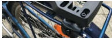
2. **MIK-Adapterplatte** wird mit einem Blech und das Blech mit dem Andersen-Kupplungskopf verbunden (alle Komponenten werden als Bausatz mitgeliefert) - einmalig.
